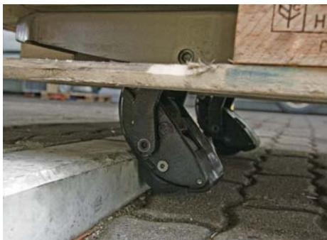
Bordsteine bis zu 70 mm Höhe sind für die patentierte Kletterrolle kein Problem.
