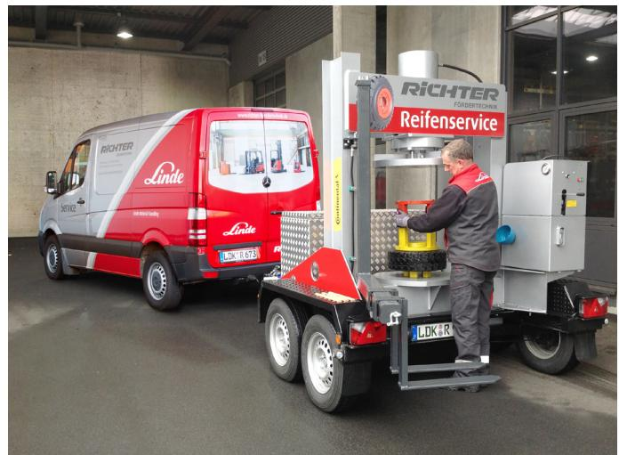
Unser Kundendienstwagen ist mit allen notwendigen Werkzeugen ausgestattet, um den Reifenwechsel bei Ihnen auf dem Gelände durchzuführen. Der Techniker montiert die abgefahrenen Räder vom Fahrzeug ab, prüft Radnabe und Felge auf Wiederverwendbarkeit und stattet Ihr Fahrzeug mit neuer Bereifung aus. Selbstverständlich kümmert er sich ebenfalls um die Entsorgung der Altreifen. Fertig!
