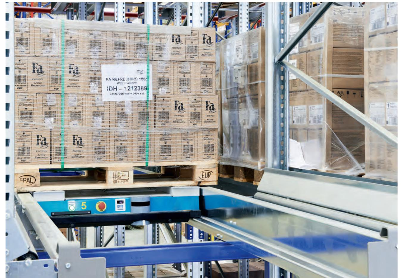
**Skalierbar:** Die Ein- und Auslagerleistung kann durch Hinzunahme eines weiteren Shuttles erhöht werden.
