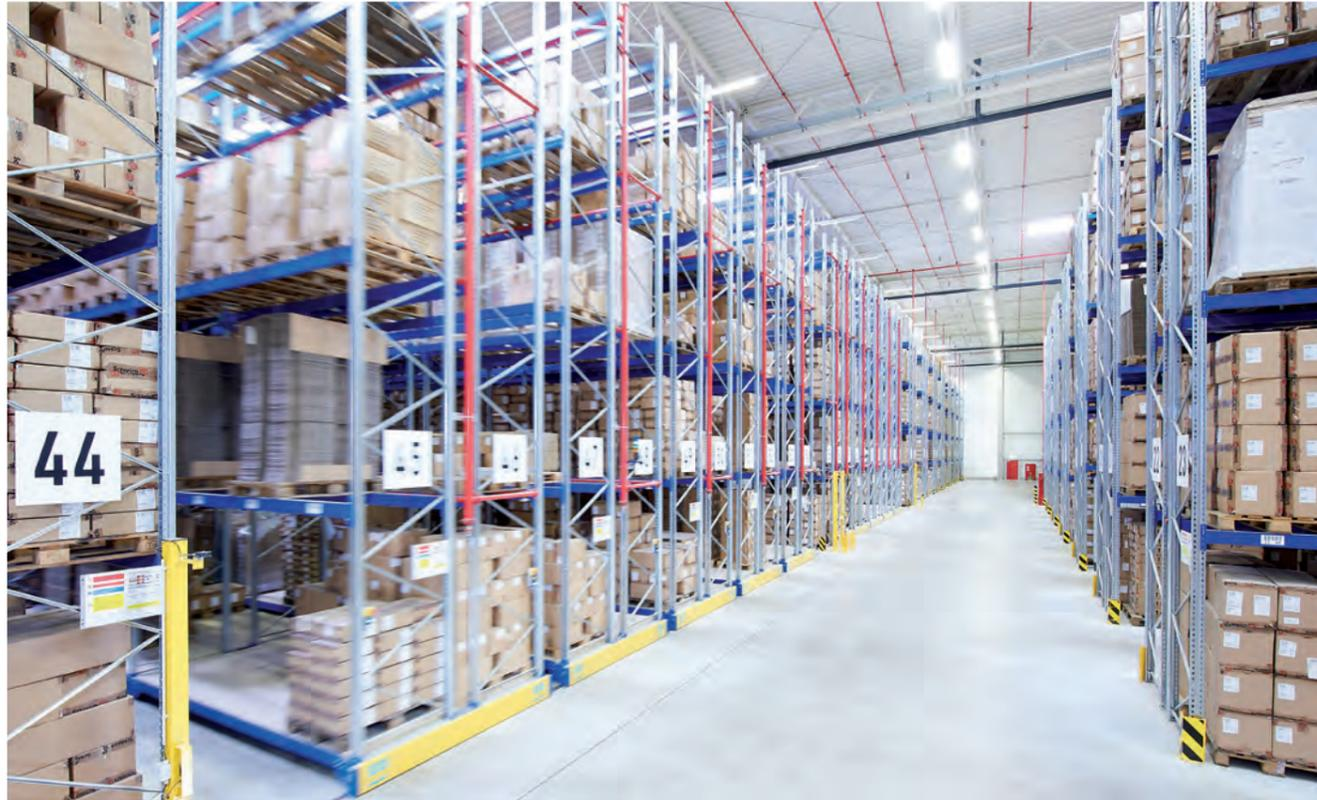
**Optimale Flächennutzung** durch verfahrbare Palettenregalsysteme, bei denen nur ein Gang als Staplergang geöffnet werden kann.
