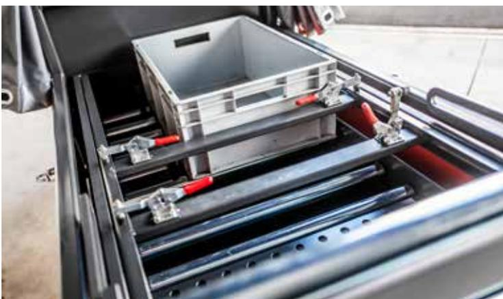
Die Lösung: Ein auf der Schlepper-Plattform befestigtes auswechselbares Transportgestell für den Lastentransport mit einer maximalen Tragfähigkeit von 450 kg. Das Gestell hat Kranösen auf dem Dach und ist dadurch leicht abnehmbar, sodass der Schlepper bei Bedarf auch ohne Aufbau genutzt werden kann. Ausgelegt auf die kundenspezifischen Bedürfnisse belaufen sich die maximalen Abmessungen der transportierbaren Lasten hier auf 1.100 x 500 x 350 mm.
