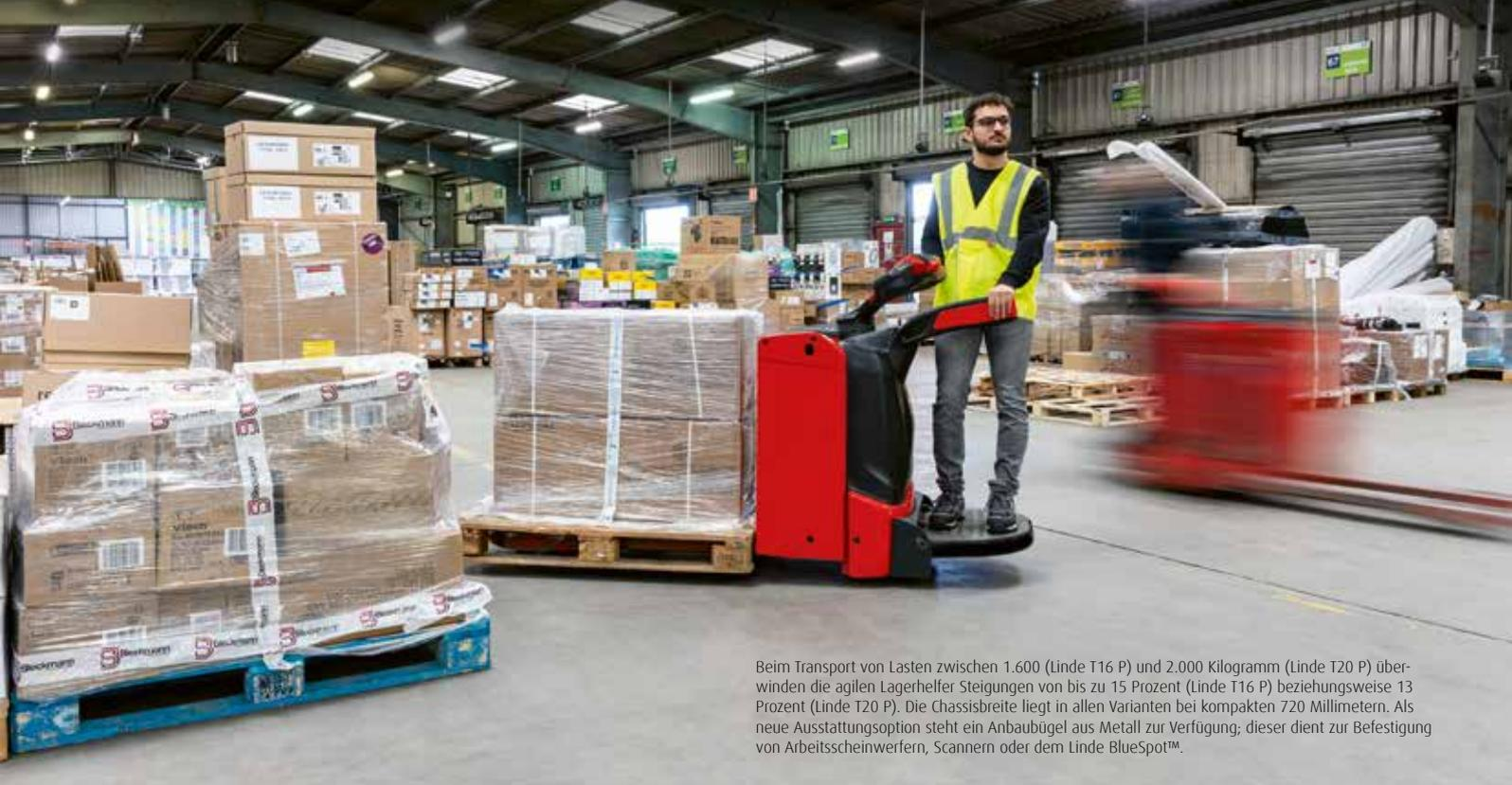
Beim Transport von Lasten zwischen 1.600 (Linde T16 P) und 2.000 Kilogramm (Linde T20 P) überwinden die agilen Lagerhelfer Steigungen von bis zu 15 Prozent (Linde T16 P) beziehungsweise 13 Prozent (Linde T20 P). Die Chassisbreite liegt in allen Varianten bei kompakten 720 Millimetern. Als neue Ausstattungsoption steht ein Anbaubügel aus Metall zur Verfügung; dieser dient zur Befestigung von Arbeitsscheinwerfern, Scannern oder dem Linde BlueSpot™.
