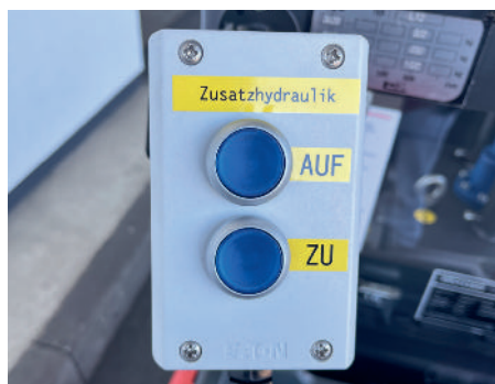
Separate Steuereinheit zum Öffnen und Schließen der Klemmvorrichtung
