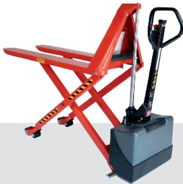
Der elektrische Scherenhubwagen EHL 1004 kann mit Fernbedienung sowie Positionskontrolle ausgestattet werden. Damit wird eine **konstante automatische Arbeitshöhe** erreicht, so dass dem Anwender eine **ergonomisch korrekte Arbeitsstellung** garantiert wird. Die Gabel hebt sich **automatisch beim Entladen** und senkt sich beim Beladen.
